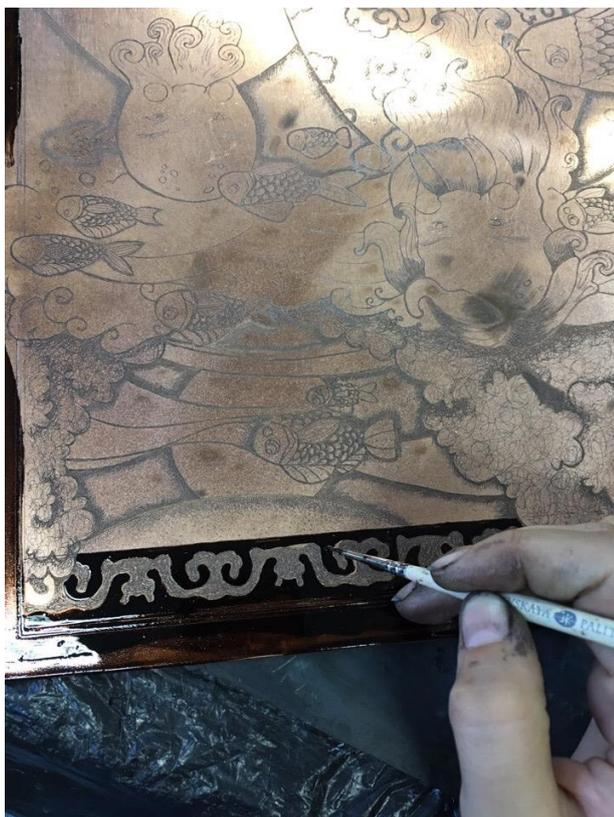
Рисунок Б.3 – Нанесение битумного лака
