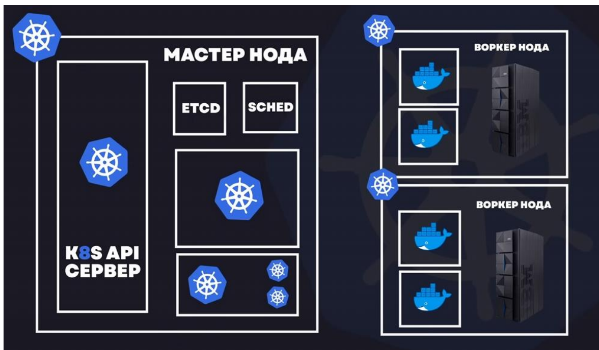
Рисунок 2.11 – Kubernetes упрощённая визуализация развёртывания на физических серверах [18]
