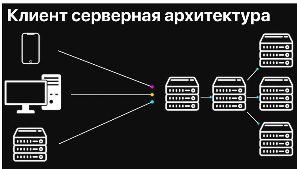
Рисунок 2.6 – Клиент-сервер в микросервисной архитектуре [13]
