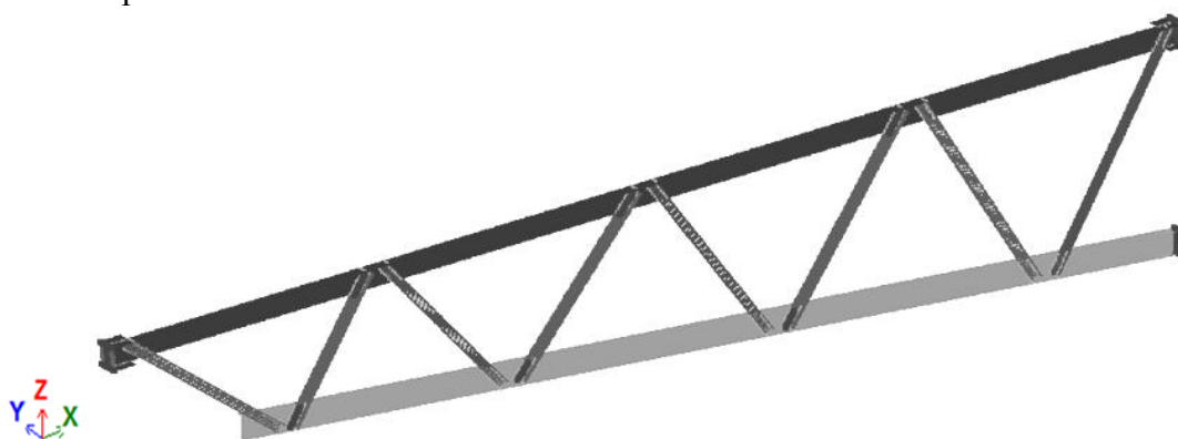
Рис. 4. Пространственная (конечно-элементная) модель половины фермы
