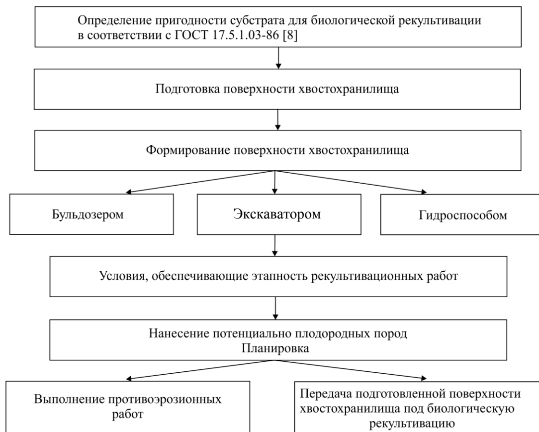
Рис. 2. Последовательность выполнения рекультивационных работ
