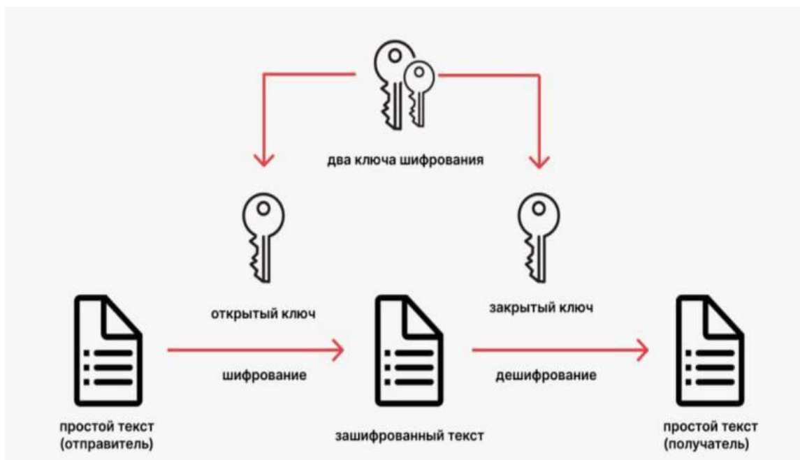
Рисунок 6 – Схема асимметричного шифрования
