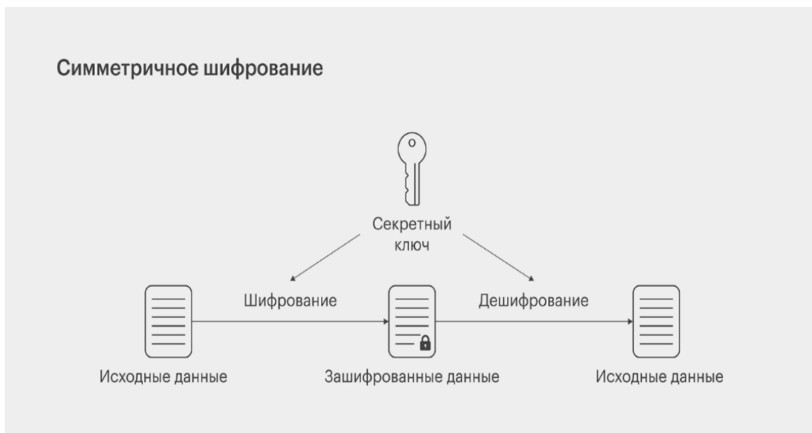
Рисунок 5 – Схема работы симметричного шифрования
