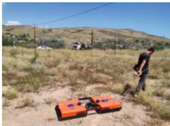
Рис. 6 – Проведение георадарных исследований на профиле
