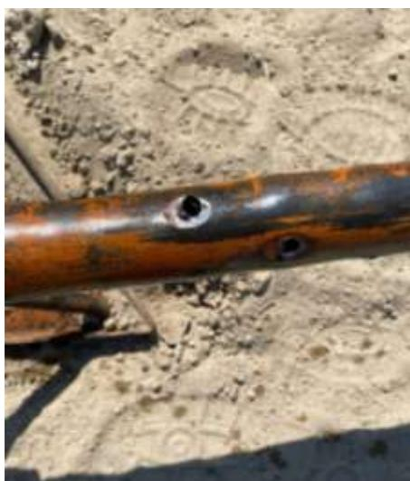
Рис. 3 – Отверстия в корпусе перфоратора
