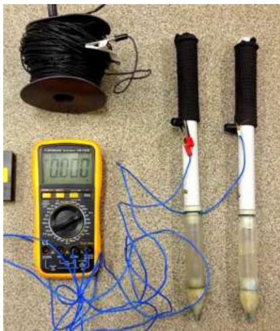
Рис. 1 – Установка для определения блуждающего тока (БТ)
