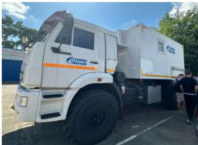
Рис. 3 – Каротажная станция
