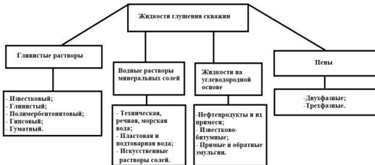
Рис. 1 – Классификация жидкостей глушения скважин
