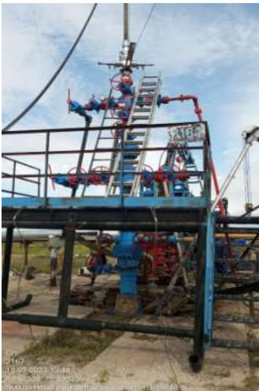
Рис. 1 – Концентрическая лифтовая колонна на устье скважины №2167 Ямбургского НГКМ (сеноманские отложения)
