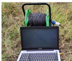
При проведении электроразведочных работ на участке исследования применялся метод электрической томографии установкой Шлюмберже (трёхэлектродная установка AMN).
