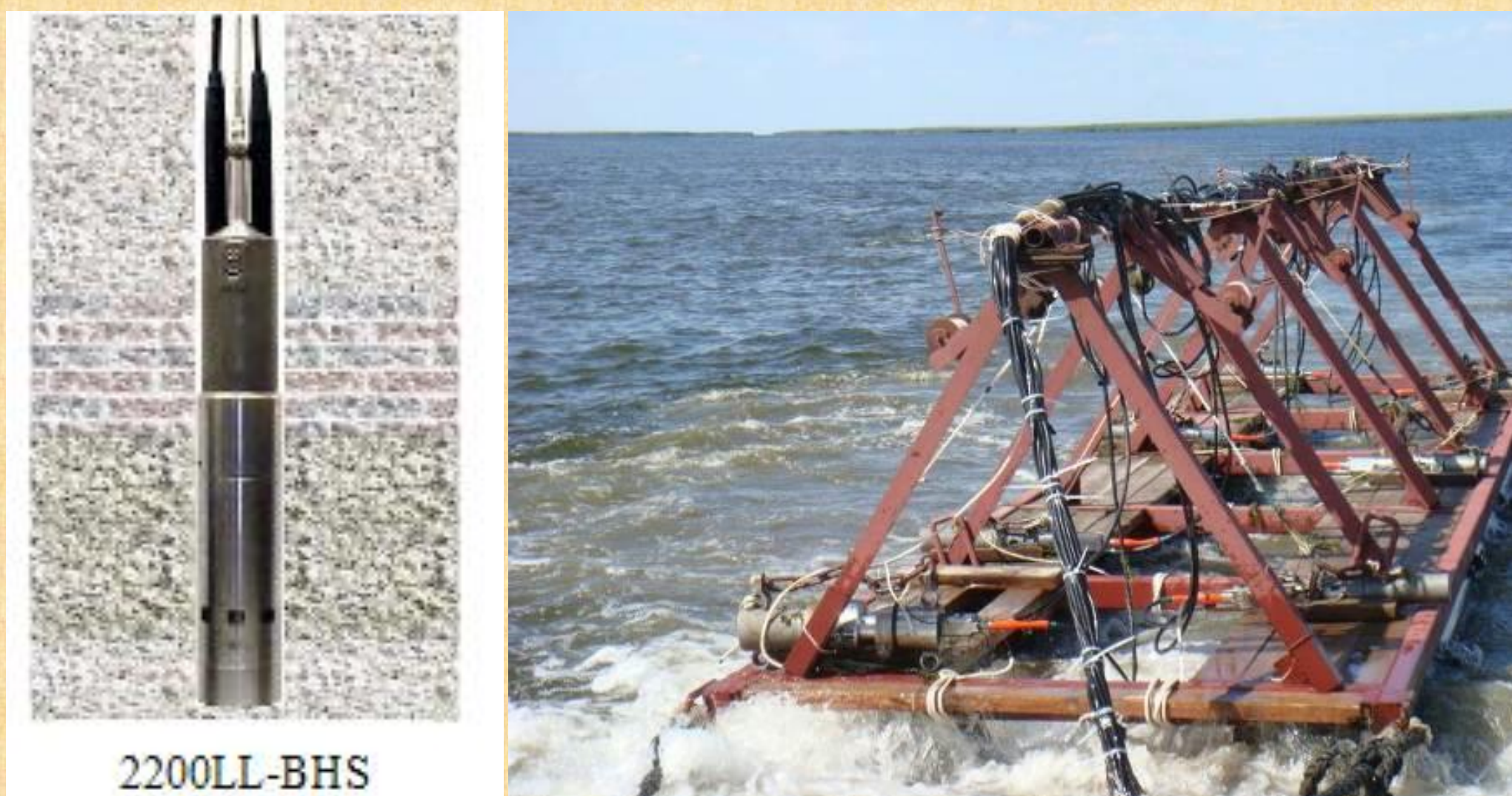
Рисунок 2 : а – пневматический источник фирмы «Bolt» конструкции 2200LL – BHS , б – плот-носитель
