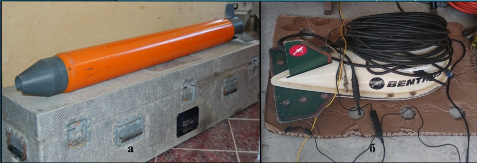
Рисунок 2 – Аппаратура, применяемая при проведении геофизических исследований: а – магнитометр SeaSpry; б – профилограф TTV-170D
