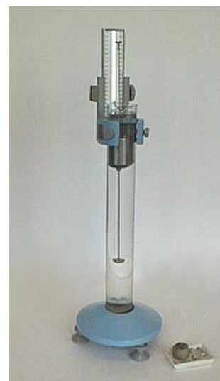
Рисунок 2, Плотнометр шлама ПШ1
