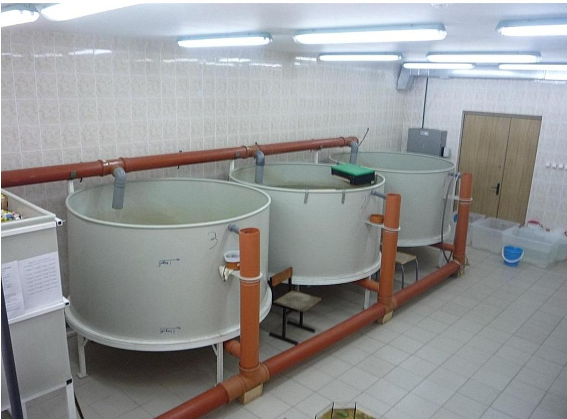
Установка замкнутого водоснабжения лаборатории перспективных технологий в
